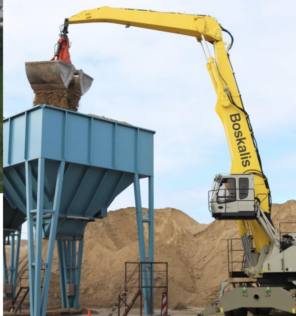
Figuur 2: Zandoverslag middels trechters
